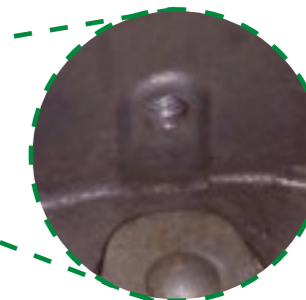
Barreno para tornillo de soporte de chicotes con cuerda pasada
